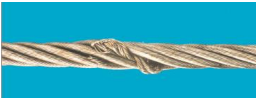
Местное сокращение диаметра (повреждение сердечника)
