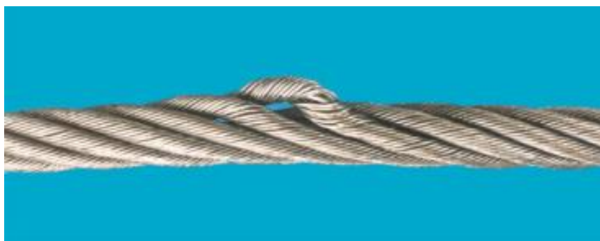
Локализованный износ (следствие абразивного истирания)
