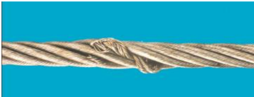
Местное сокращение диаметра (повреждение сердечника)
