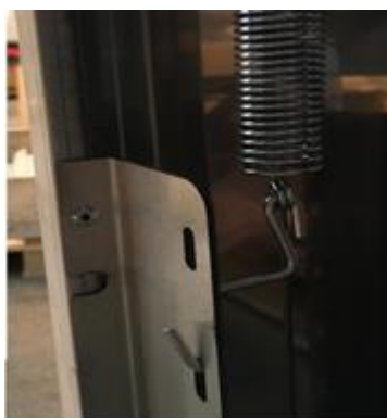
рекомендуемое крепление пружины
