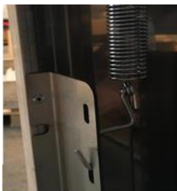
рекомендуемое крепление пружины
