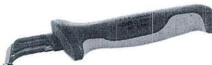
Рис.8 Нож для снятия изоляции.
