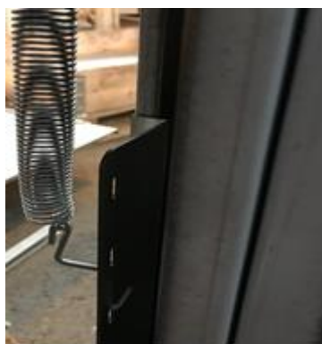
Рекомендуемое крепление пружины внизу.
