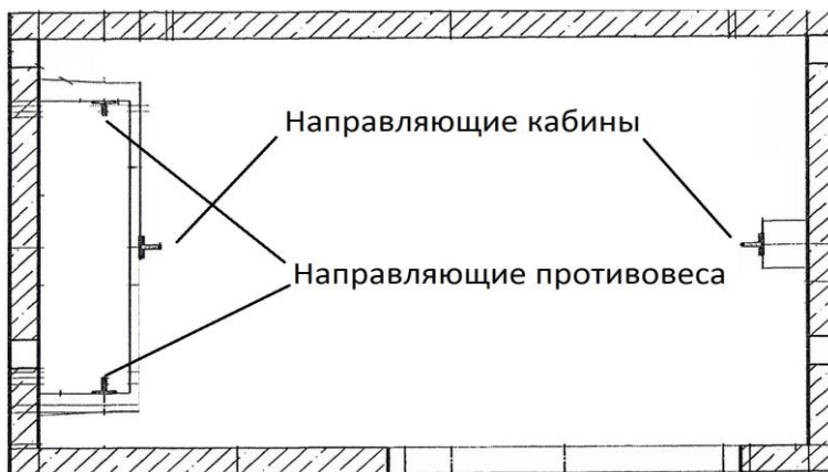
Рис. 1 Боковое расположение противовеса.
